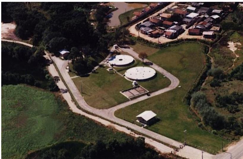
Fonte: Estação de Tratamento de Esgotos (ETE) Colombo, projetada pela Concessionária SANEPAR com capacidade de 70 l/s (1998), construída pela empresa SEF Saneamento. Acervo pessoal do autor.
